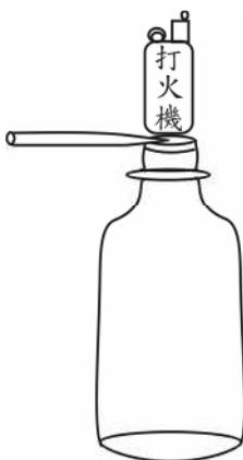
圖二、用打火機壓扁(封住)管口
